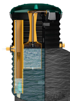
Требуемый уровень воды в станции после монтажа
